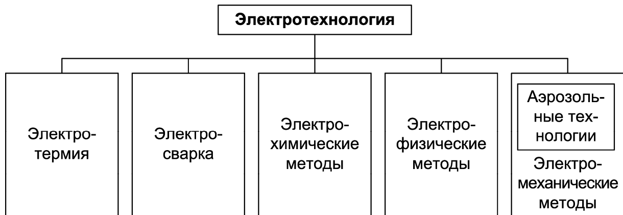
Рис. 1.1. Классификация электротехнологических процессов
