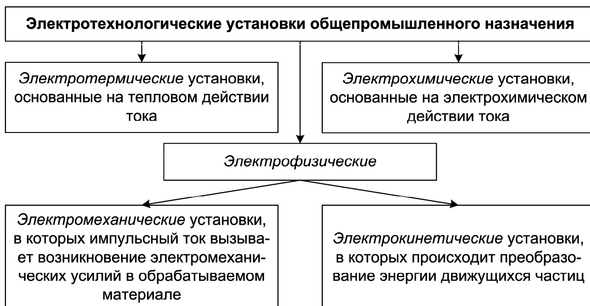
Рис. 1.4. Основные группы электротехнологических установок общепромышленного назначения
