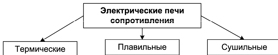
Рис. 2.10. Классификация ЭПС по технологическому назначению
