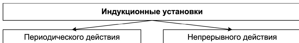
Рис. 2.31. Классификация индукционных установок по режиму работы
