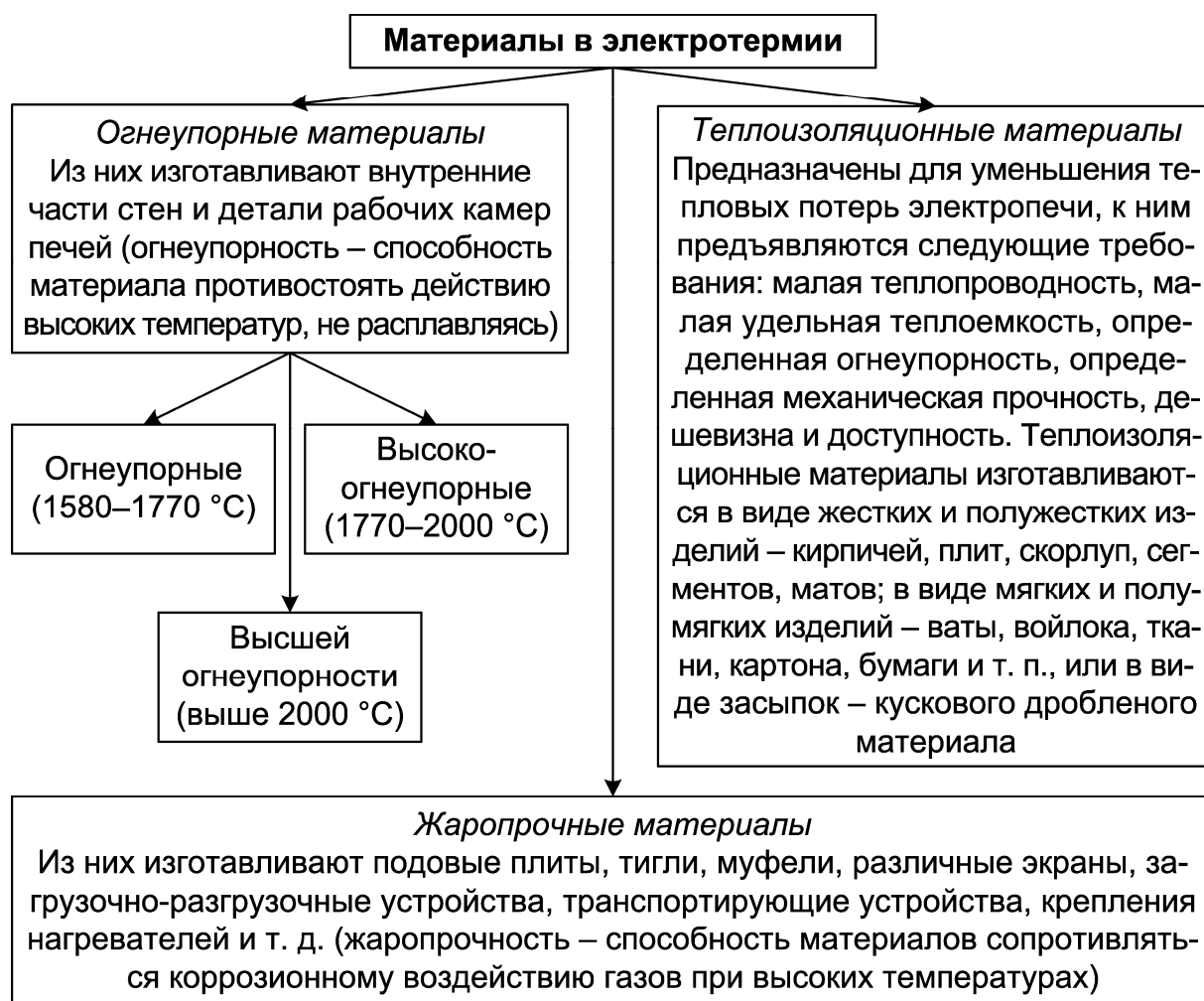
Рис. 2.2. Классификация материалов в электротермии
