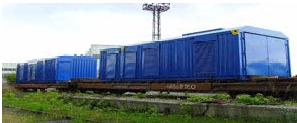
Рисунок 5 – Дизельные электрические станции
