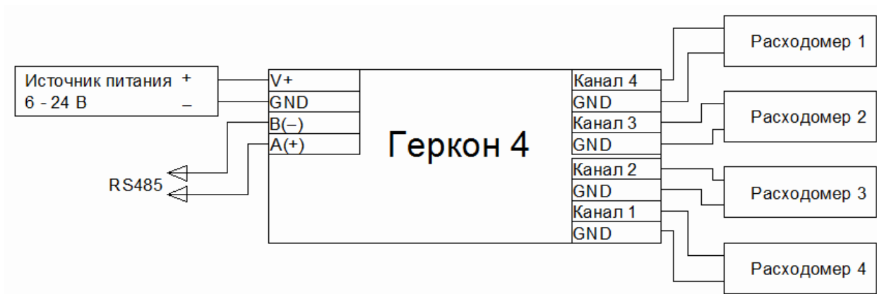
Рисунок 2 - Схема подключения счетчика импульсов Геркон 4
