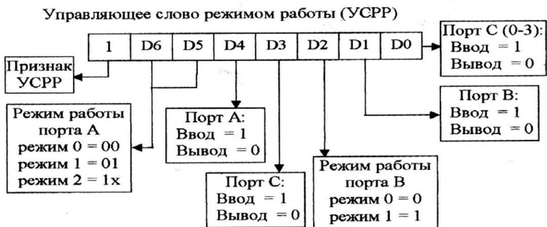
Рисунок 6 – Формат УСРР порта КР580ВВ55А
