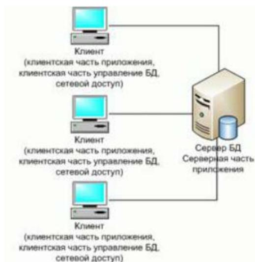
Рисунок 3 – Двухуровневая клиент-серверная архитектура
