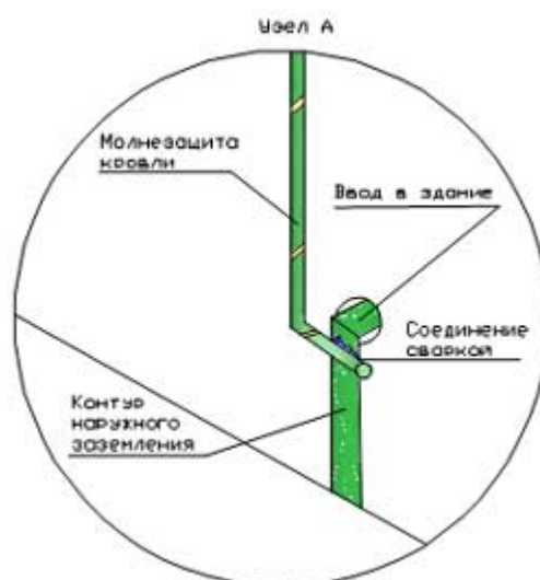
Рисунок 6 - Узел молниезащиты ТП
