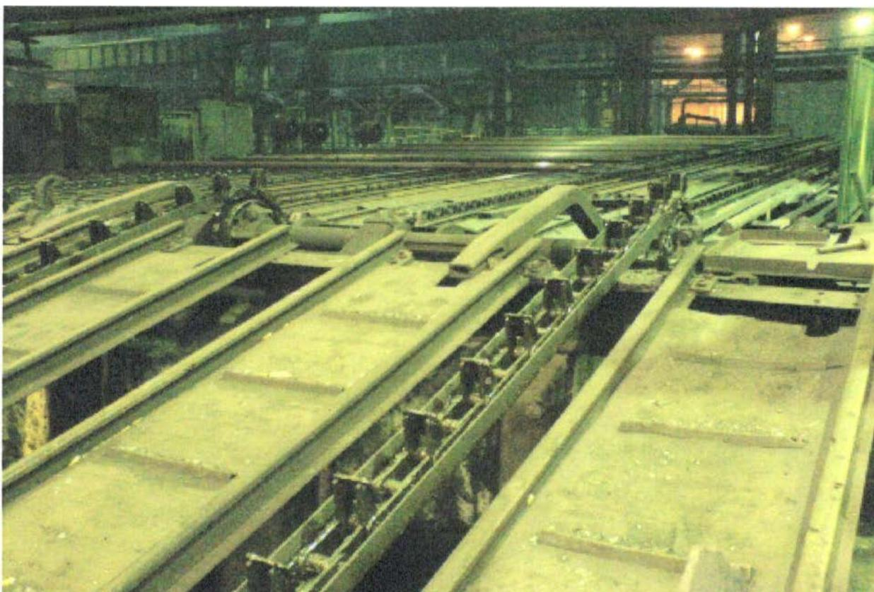
Рисунок 10 – Охлаждающий стол цепного типа ТПУ 140
