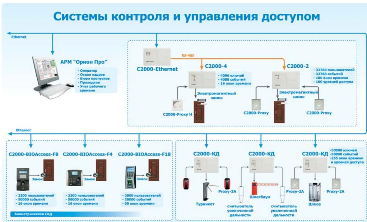
Рисунок 7 – Схема работы ИСО «Орион»
