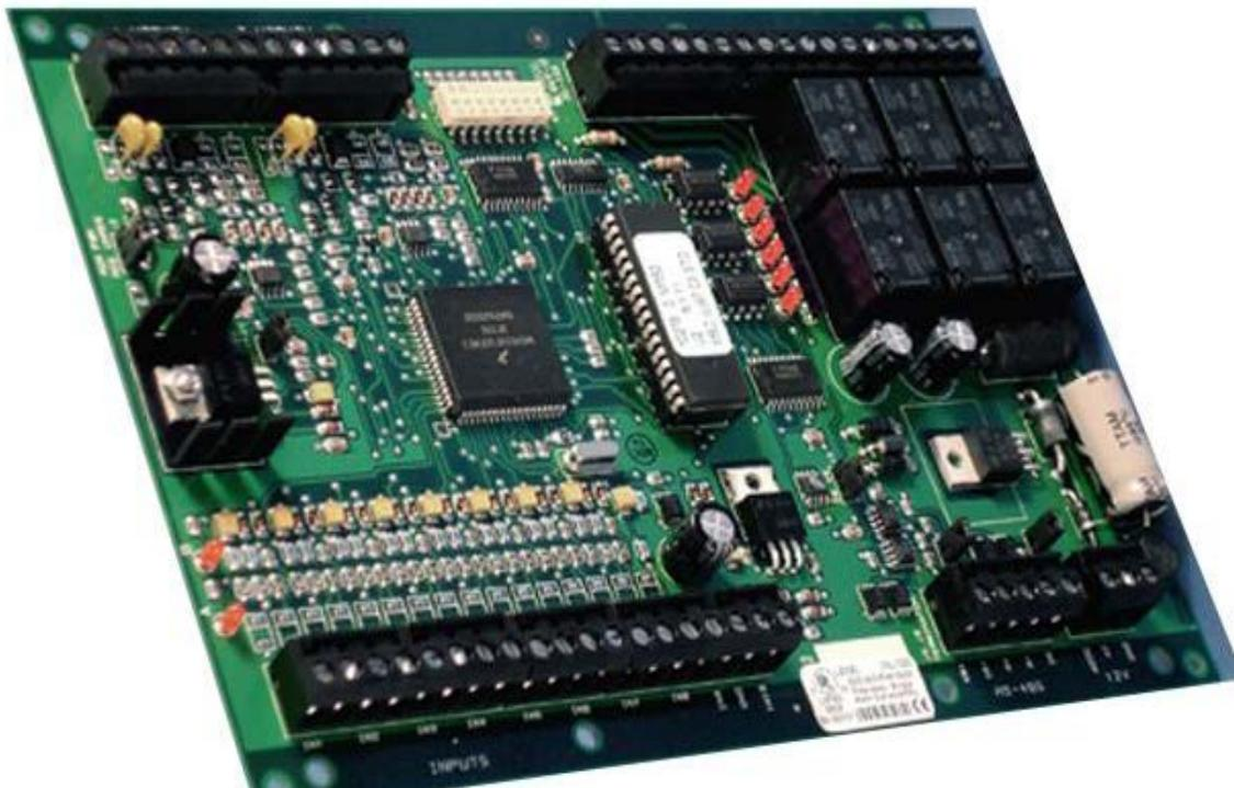
Рисунок 18 – Модуль управления NGP-1320-UMP
