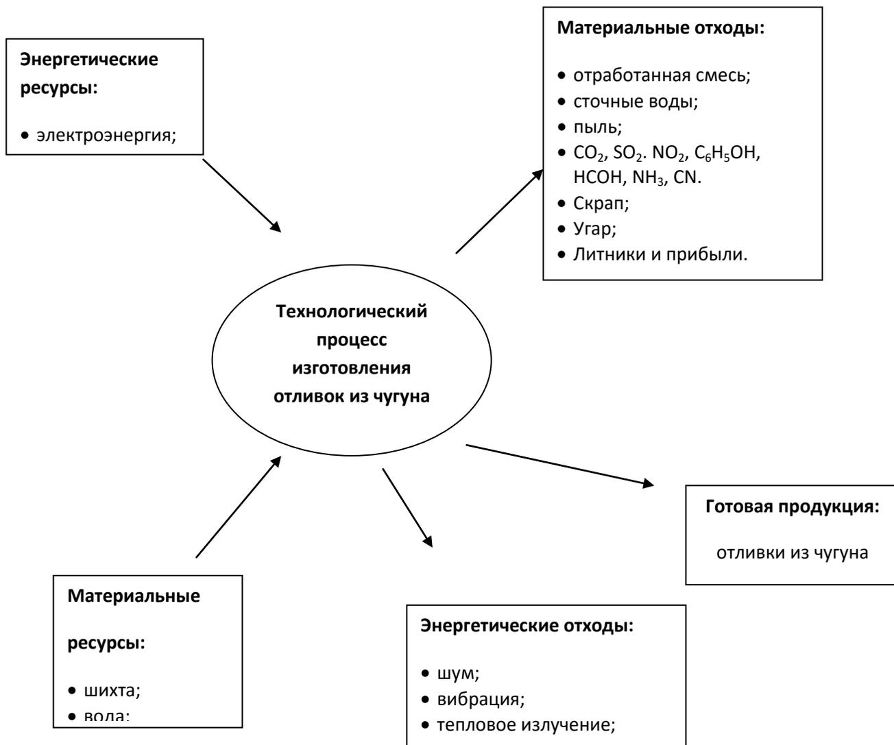
Рисунок 1 –Схема технологического процесса изготовления отливок
