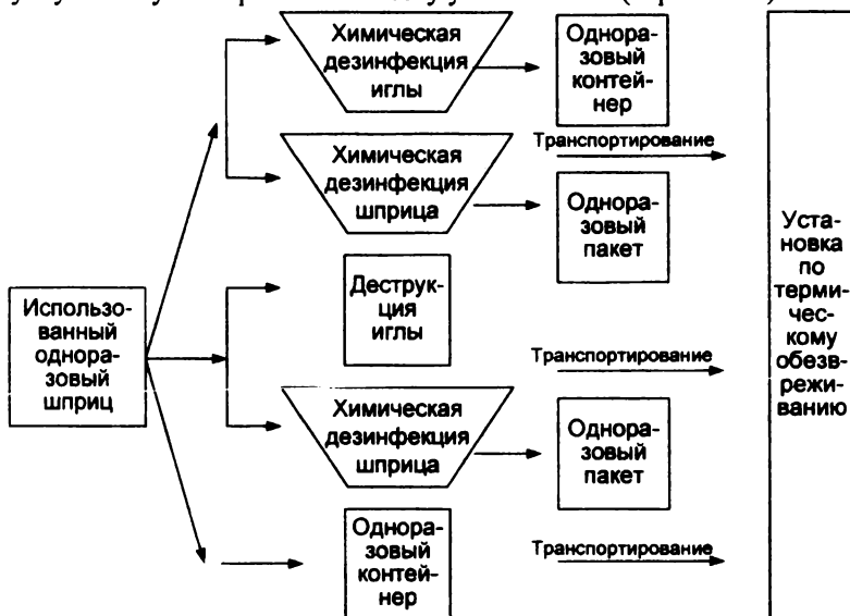
Различные варианты безопасного обращения с использованными шприцами инъекционными одноразового применения в зависимости от технической оснащённости ЛПУ
