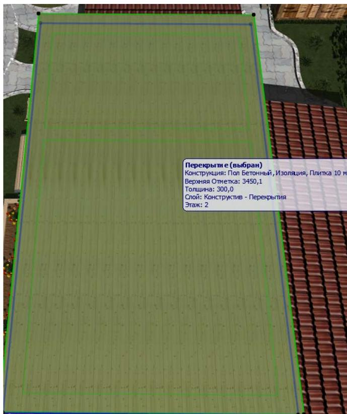
Рисунок 31 — Выделение перекрытия
