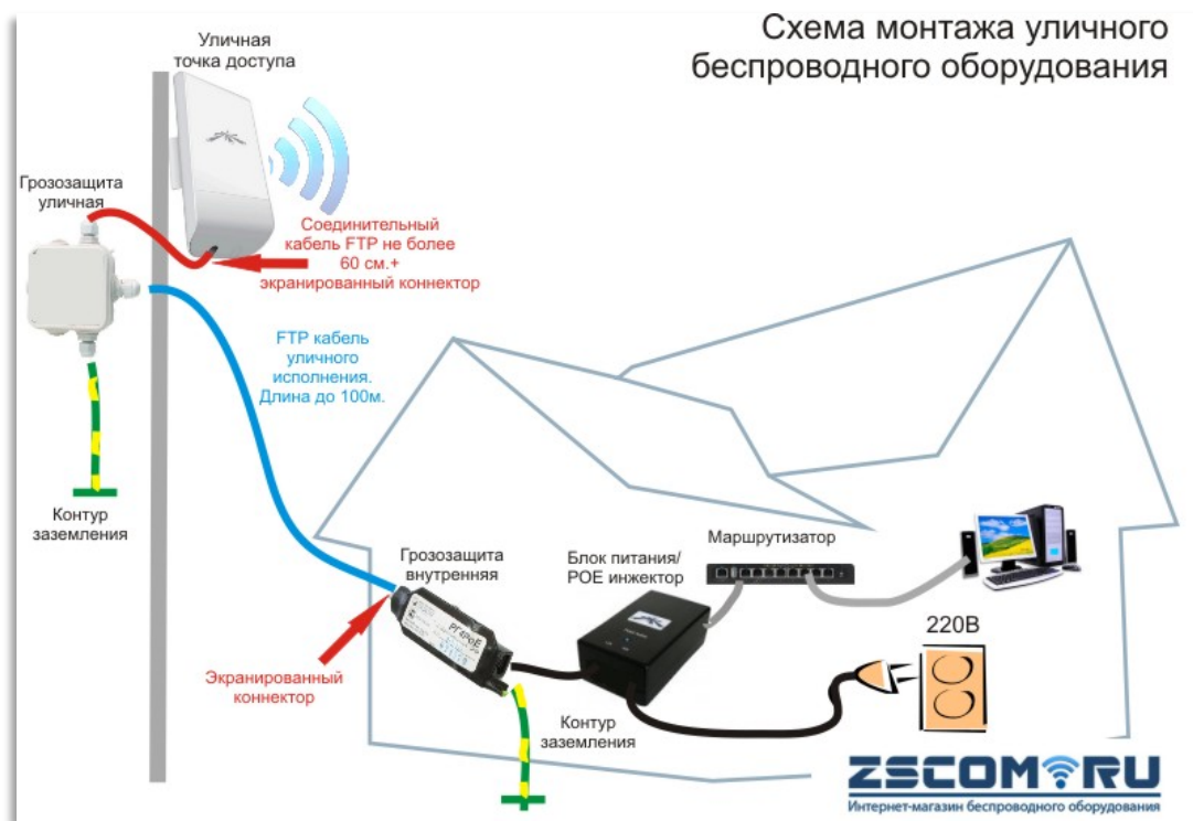
Рисунок 25 – Схема монтажа беспроводного оборудования
