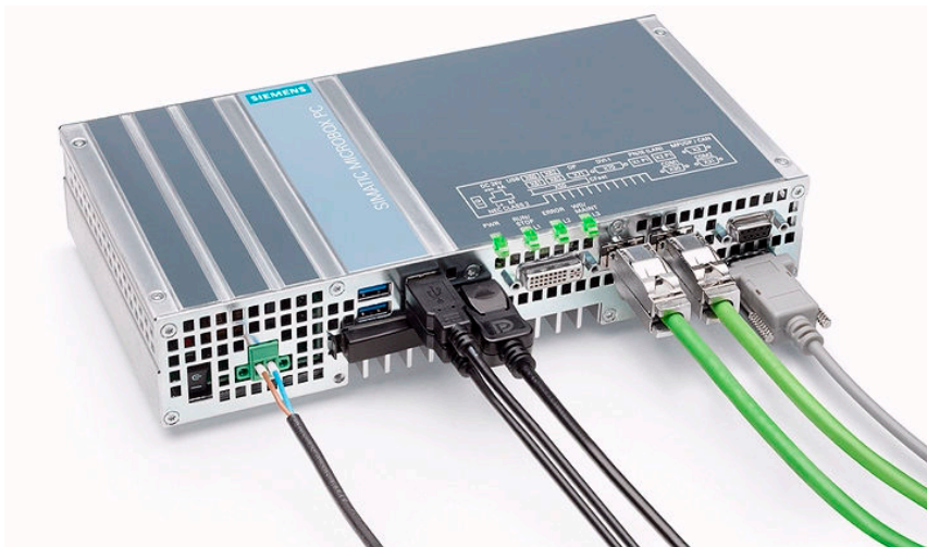
Рисунок 12 – Производственный компьютер SIMATIC IPC427D
