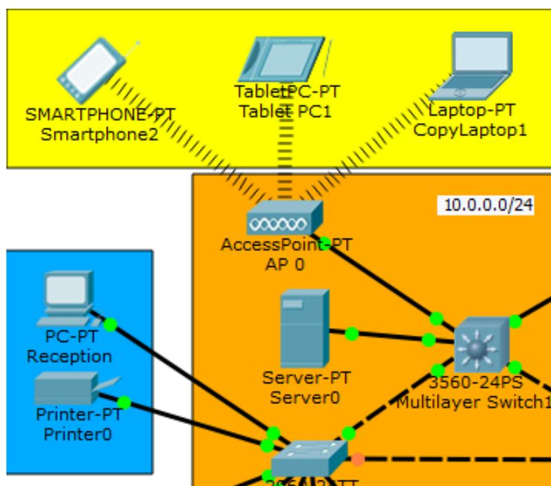
Рисунок 15 — Построение беспроводной сети
