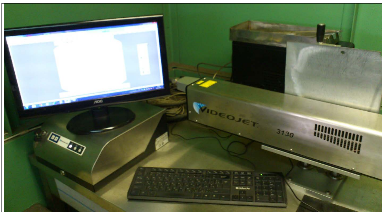
Рисунок 3 — Система лазерной маркировки с управляющим ПК
