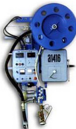
Рисунок 1.16 – Автомат для дуговой сварки А-1416
