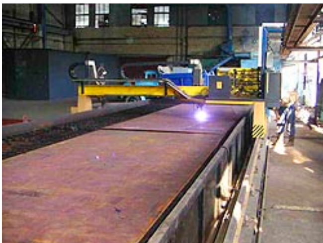
Рисунок 1.13 – Машина термической резки. Тип: ULTRAREX™ UXL
