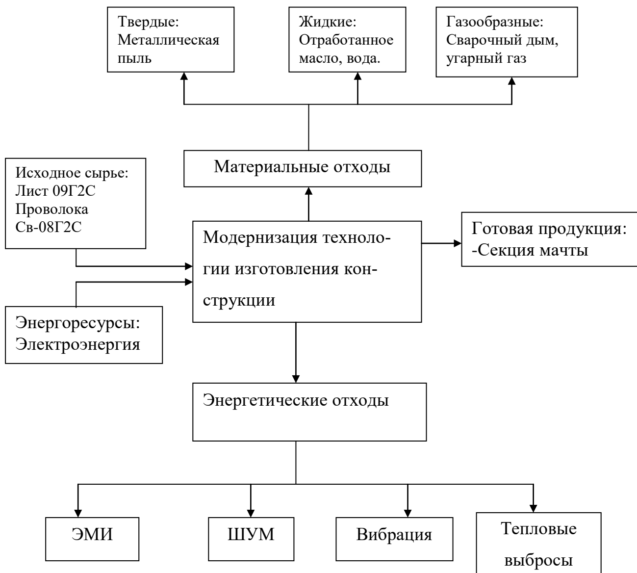
Рисунок 5.1- Схема технологического процесса сварки
