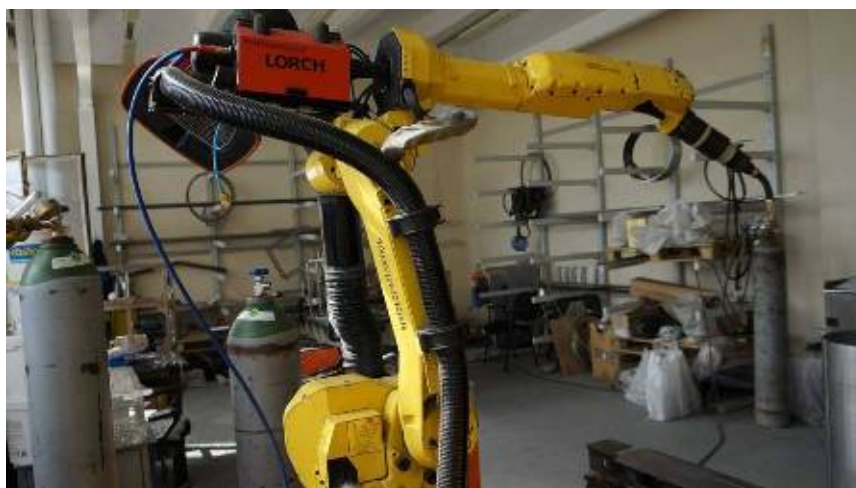
Рисунок 4.6 - Роботизированный технологический комплекс FANUC ARC Mate 100iC с MIG сваркой.
