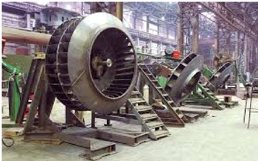
Рисунок 4.8 - Стенд для сварки рабочих колес
