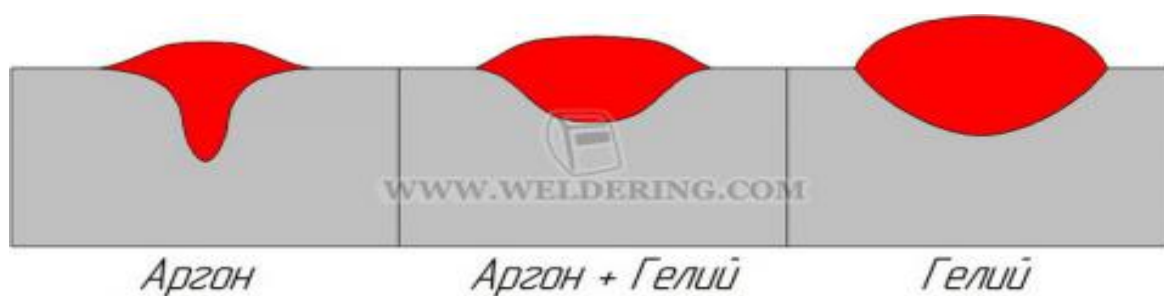
Рисунок 4 – Форма шва и проплавление для различных защитных газов
