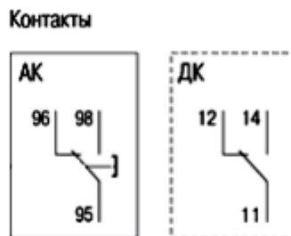
Рисунок В.8 – Электрические схемы дополнительного и аварийного контактов
