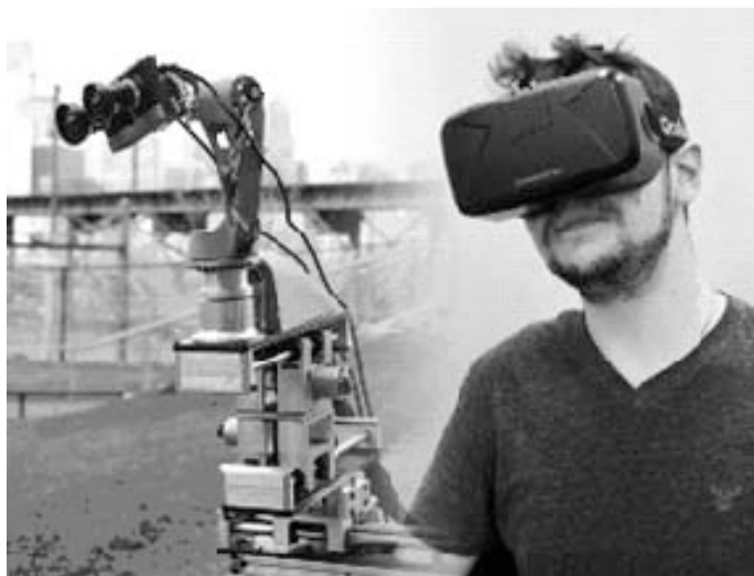
Рисунок 9 — Робот DORA Университета Пенсильвании, копирующий движения человека
