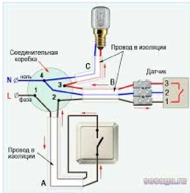
Рисунок 18 - Подключение датчика движения напрямую
