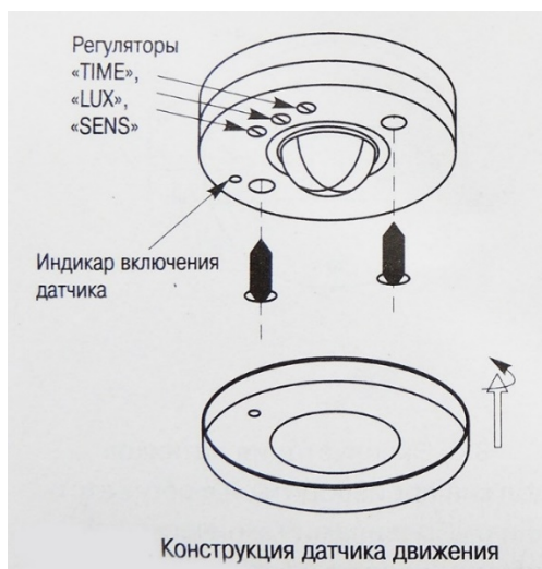
Рисунок 15 - Конструкция датчика движения
