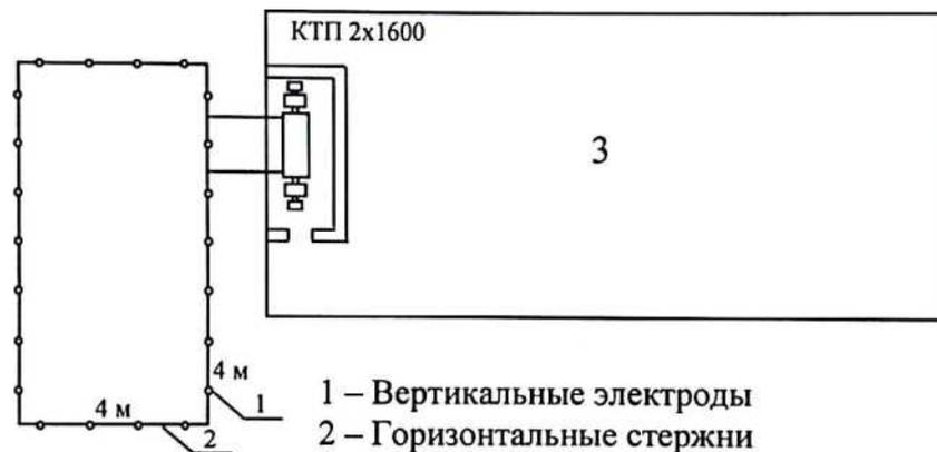
Рисунок 7- контур заземления ЦТП
