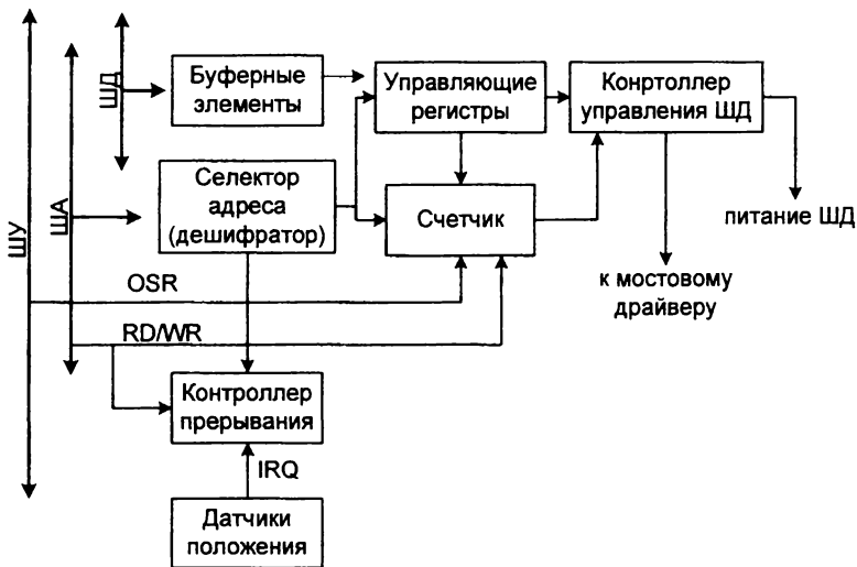
Рис. 2. Функциональная схема контроллера шагового двигателя
