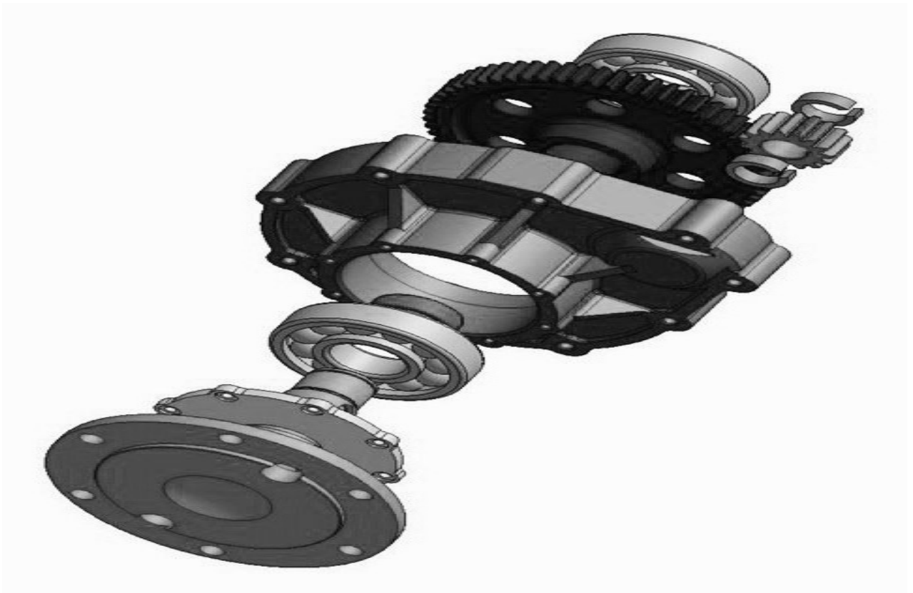
Рисунок 1 - Крышка редуктора лебедки в сборочном узле
