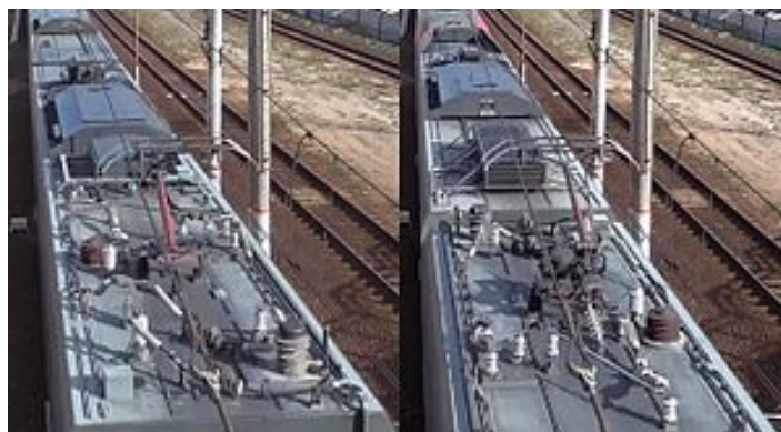
Рисунок 6 – Крышное оборудование, вид с двух сторон
