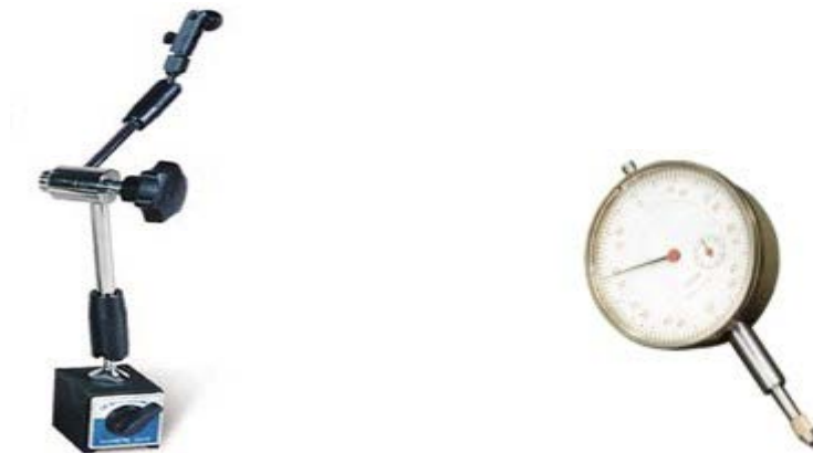
Рисунок 4.7 – Магнитная стойка SMG1 и индикаторная головка ИЧ-02
