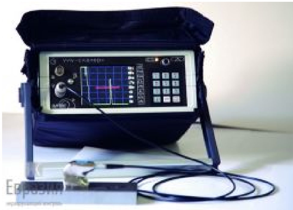
Рисунок 7-Дефектоскоп ультразвуковой УИУ «Скаруч»
