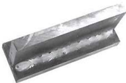
Рисунок 6 – Внешний вид углового шва, выполненного в смеси Ar+CO 2 проволокой Св-08Г2С диаметром 1,2 мм при I_{св} = 260А , U_{д} = 28 В
