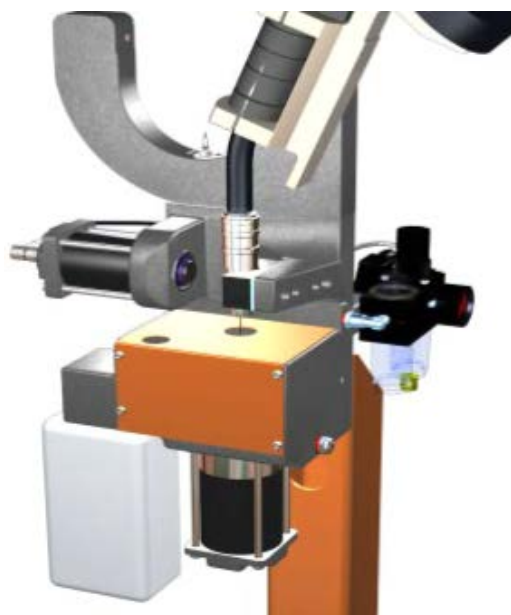
1 – Очиститель сопла; 2 – кусачки для сварочной проволоки; 3 – блок измерения (калибровочный блок)
