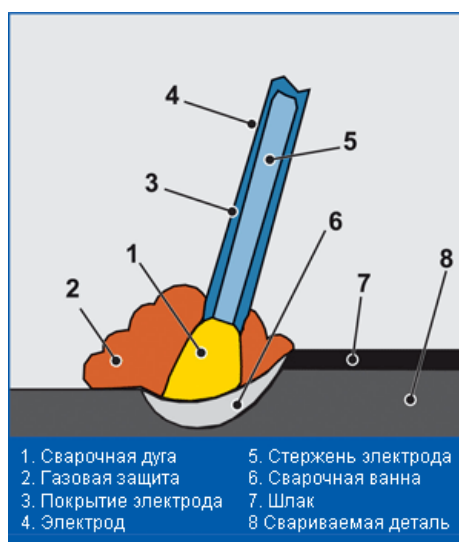
Рисунок 1.3- Схема ручной электродуговой сварки
