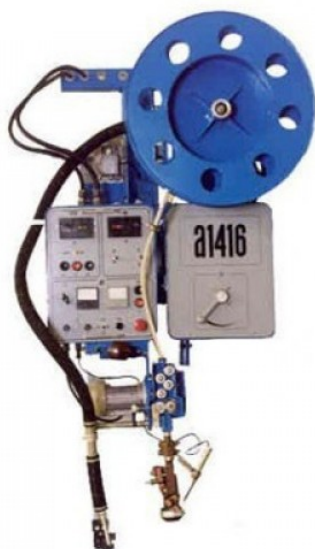
Рисунок 1.8 - Сварочная головка А-1416
