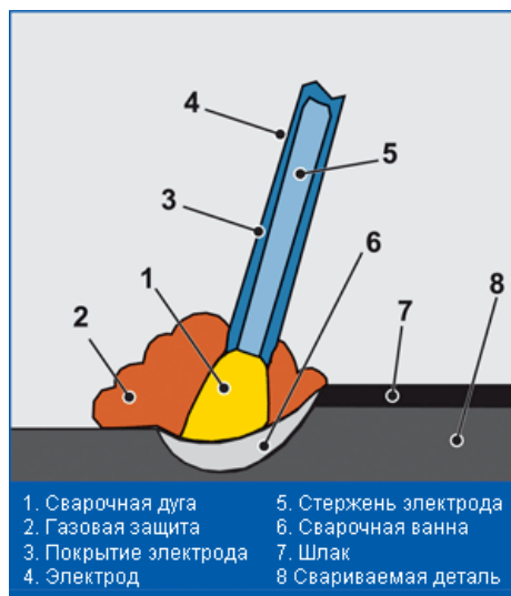
Рисунок 1.4- Схема ручной электродуговой сварки
