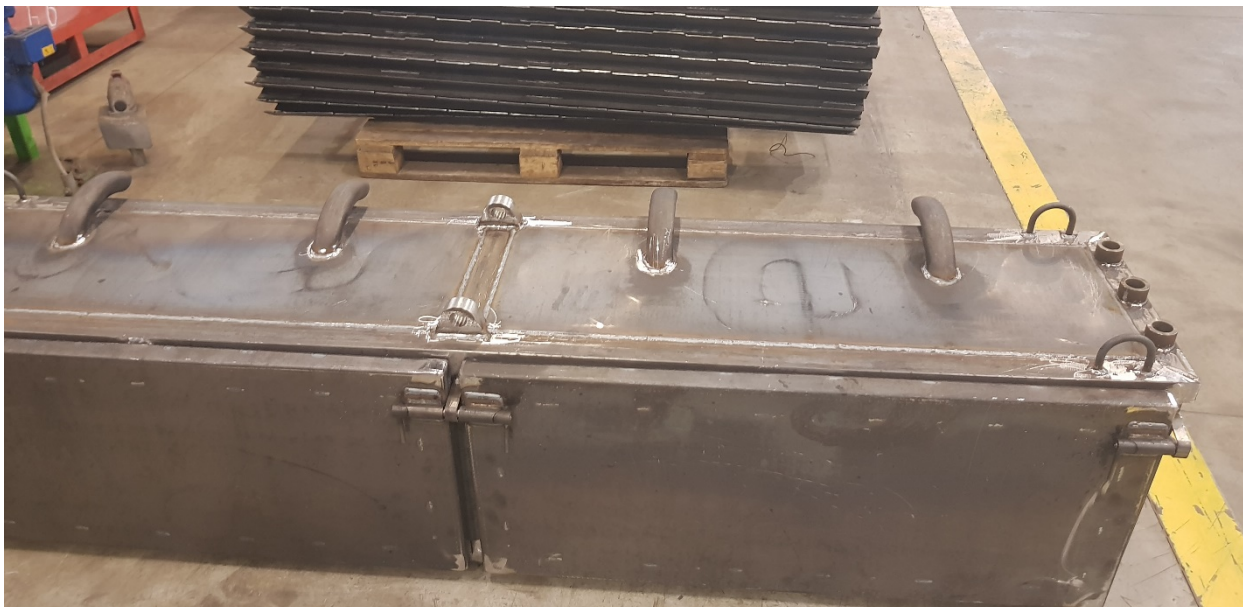
Рисунок 1.3 – Блок аккумуляторов локомотива
