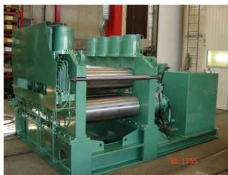
Рисунок 11 – Листопрямильная машина PRH 360x1000.
