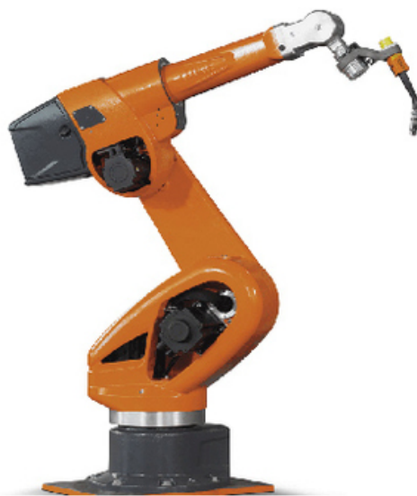
Рисунок 15 - Сварочный робот QRC-320
