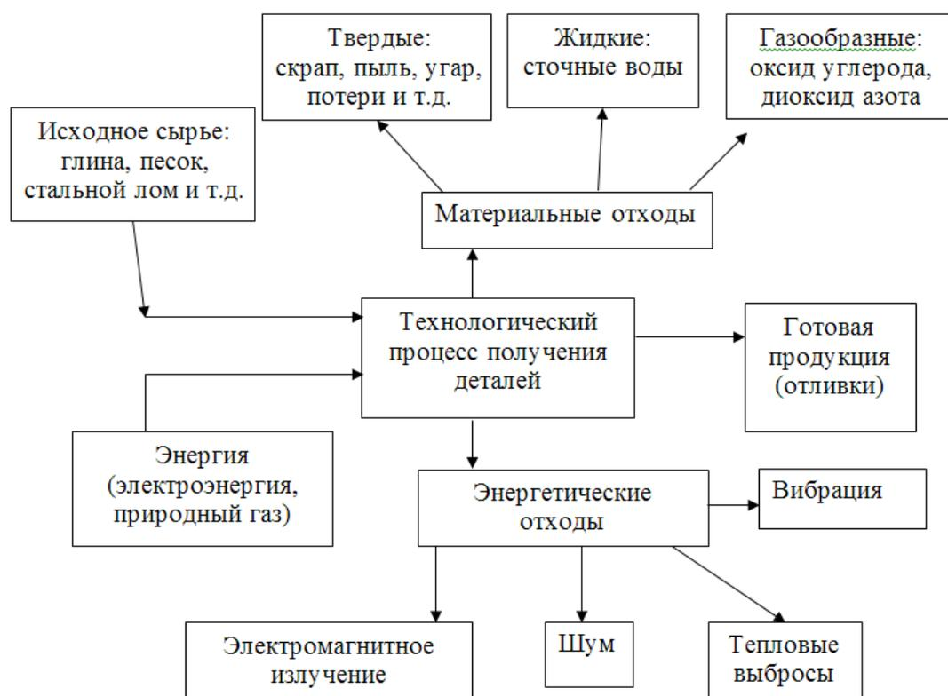
Рисунок 1 - Схема технологического процесса получения отливок
