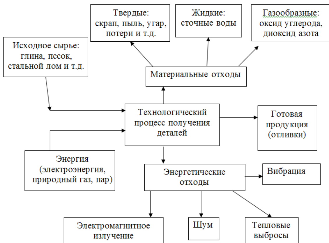
Рисунок 2 - Схема технологического процесса получения отливок
