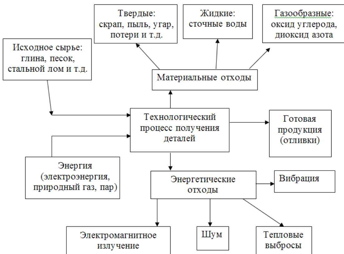
Рисунок 1 - Схема технологического процесса получения отливок
