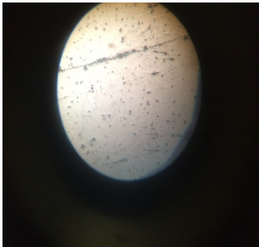
Рисунок 16. Микроструктура образца хромистого чугуна №2.
