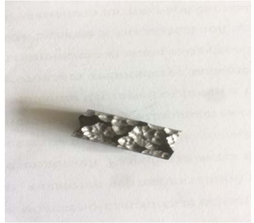
Рисунок 15. Микроструктура образца хромистого чугуна №1.
