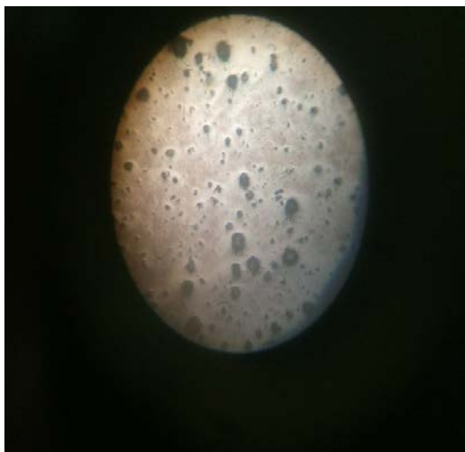
Рисунок 10. Микроструктура образца высокопрочного чугуна №1
