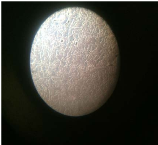
Рисунок 9. Микроструктура образца серого чугуна №5
