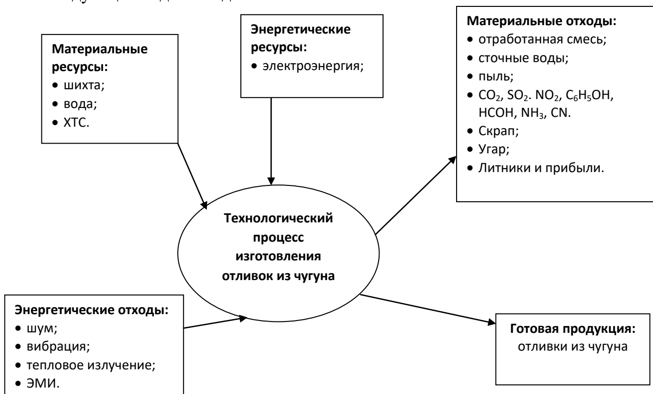
Рисунок 2 – Схема технологического процесса изготовления отливок
