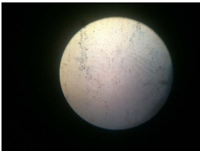
Рис 2.7 Микроструктура образца №3 (сталь 15X13Л)
