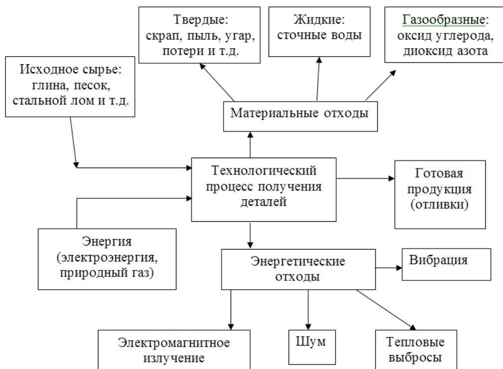
Рисунок 2 - Схема технологического процесса получения отливок
