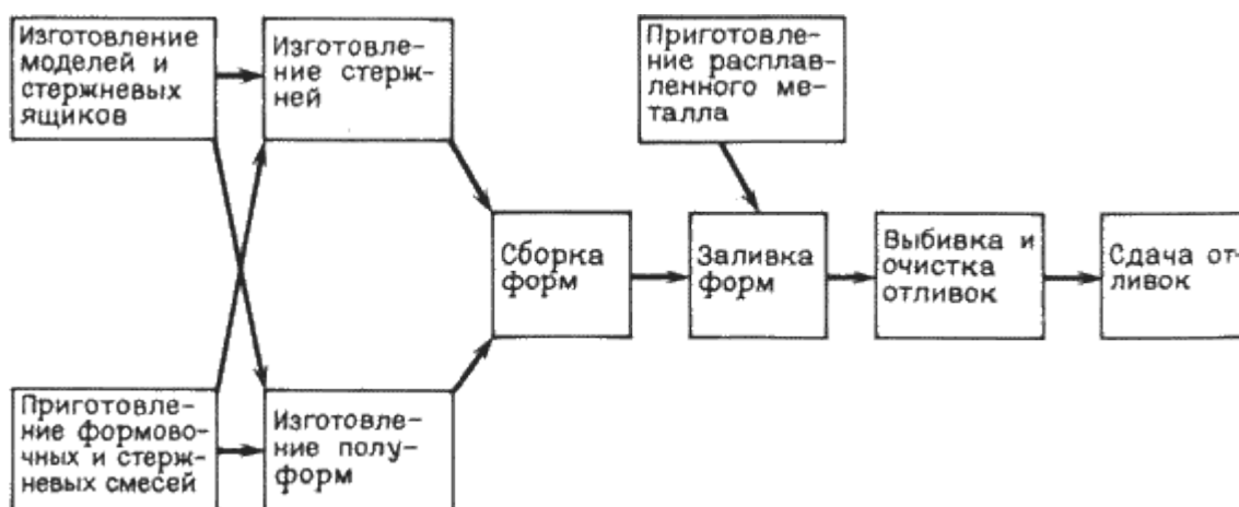
Рисунок 3 - Схема технологического процесса изготовления отливок в песчаных формах
