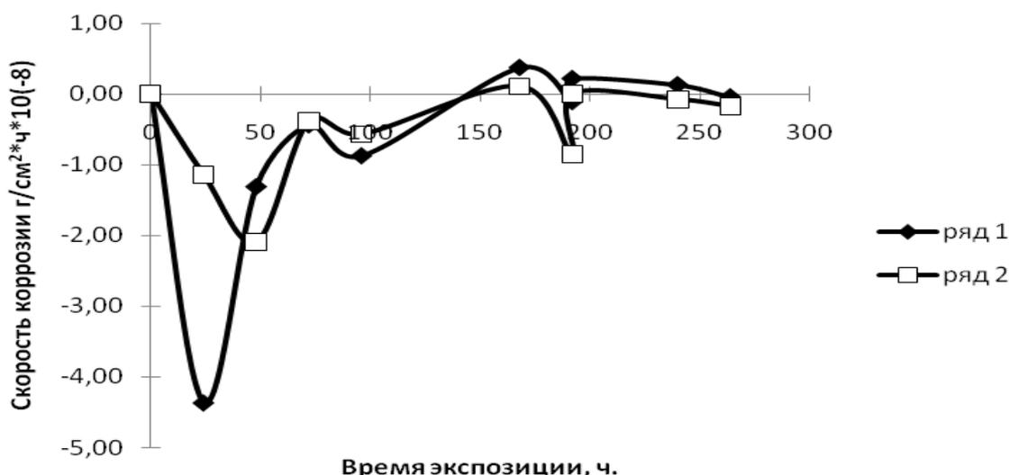
Рисунок 13. Зависимость скорости коррозии сплавов 15X13 от времени экспозиции в растворах  $\text{NaNO}_3$  (5%)+ $\text{NaCl}$ (3%) (ряд 1),  $\text{NaNO}_3$  (5%) + $\text{NaCl}$ (3%) содержащий метионин 0,2 мас.% (ряд 2).
