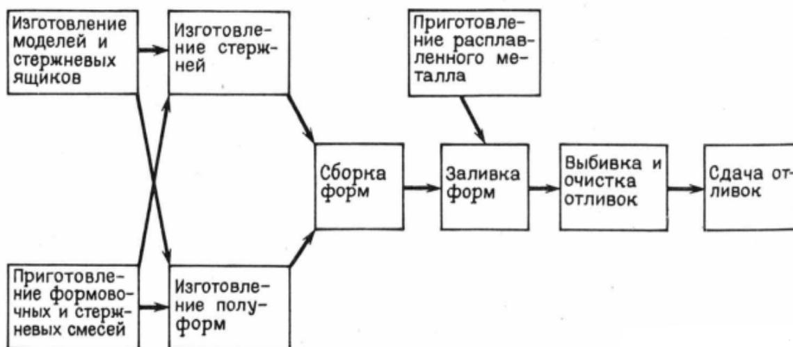
Рисунок 1. Схема технологического процесса изготовления отливок в песчаных формах[3]
