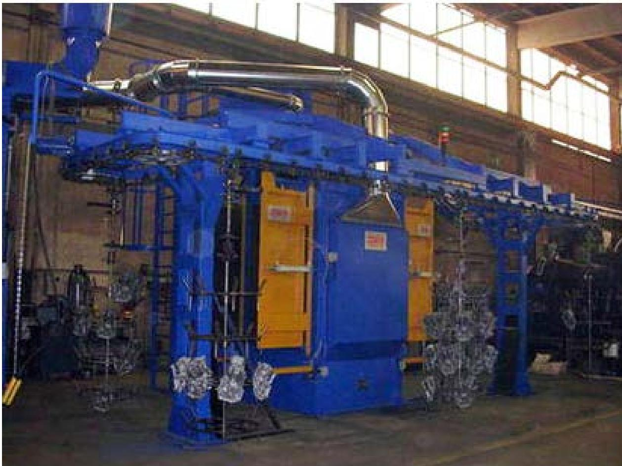
Рисунок 10 – Дробеметная установка серии GSA фирмы COGEIM
