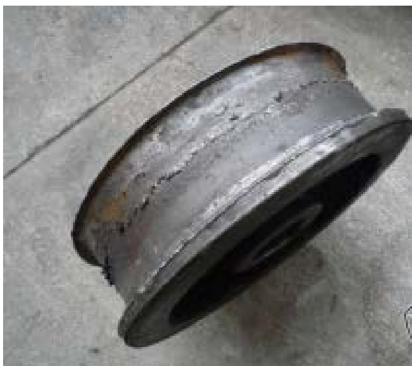
Рисунок 6– Основные дефекты колеса мостового крана при которых эксплуатация крана запрещается
