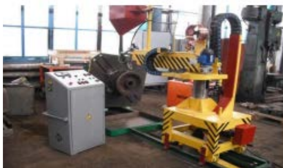
Рисунок 12 – Установка для наплавки крановых колес УНК–112
