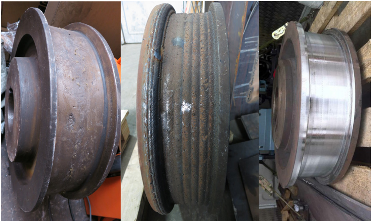
Рисунок 7–Ходовое колесо с износом
