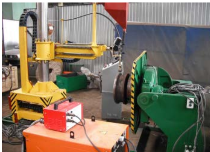
Рисунок 10– Внешний вид установки наплавки крановых колес УНК–112
