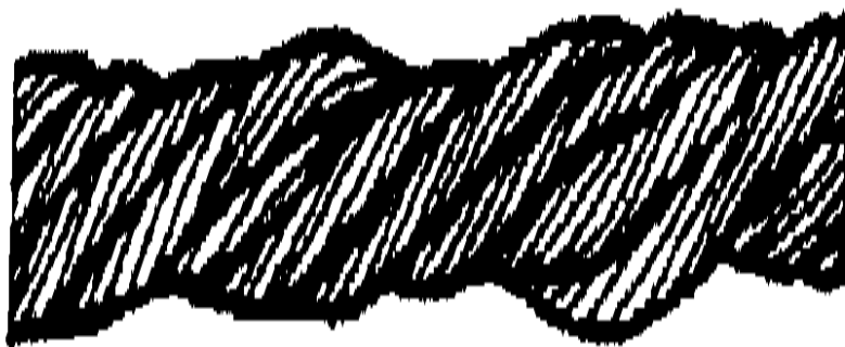
Рисунок 10 – Местное уменьшение диаметра каната на месте разрушения органического сердечника
