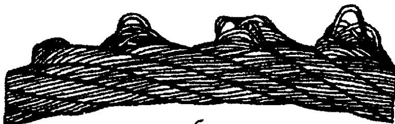
Рисунок 8 – Выдавливание проволок прядей: а - в одной пряди; б - в нескольких прядях
