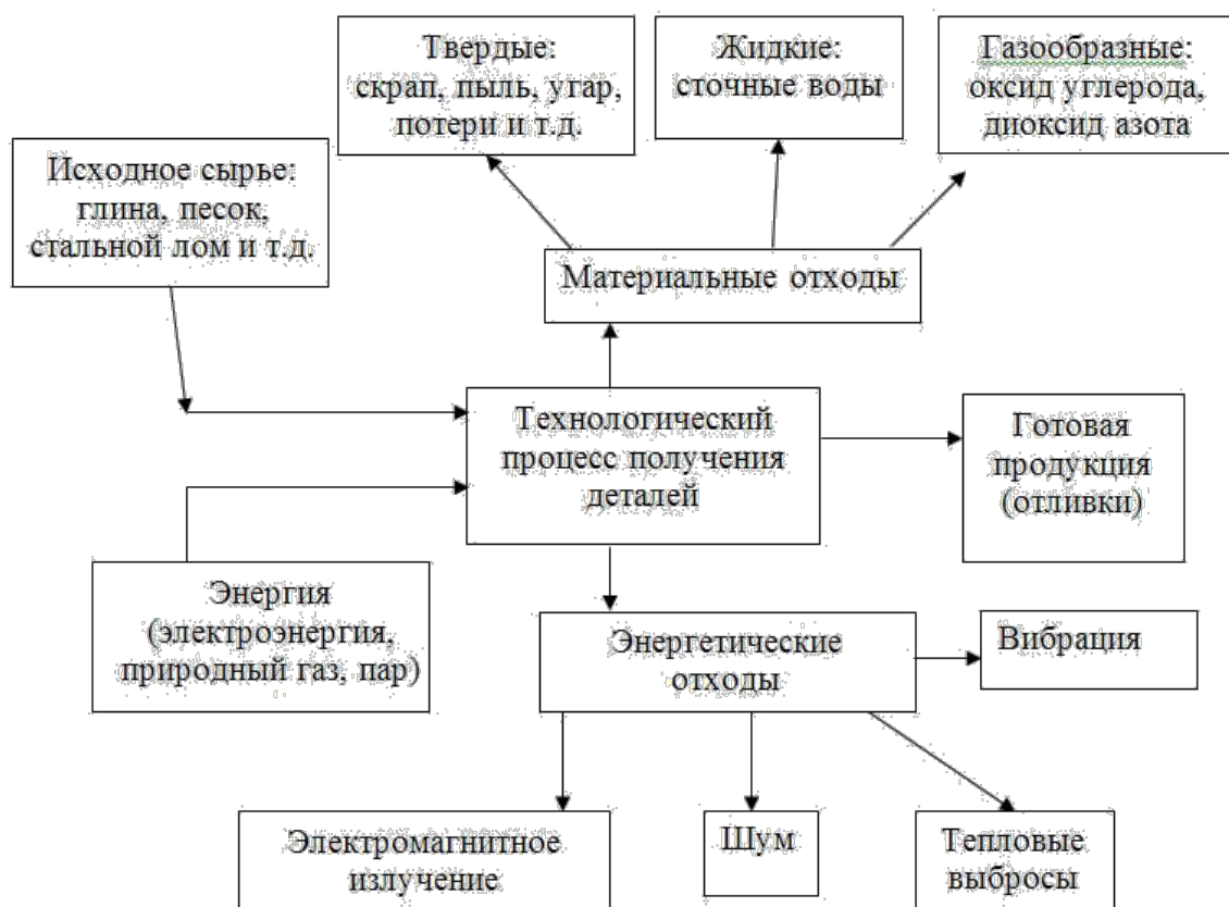
Рисунок 2 - Схема технологического процесса получения отливок
