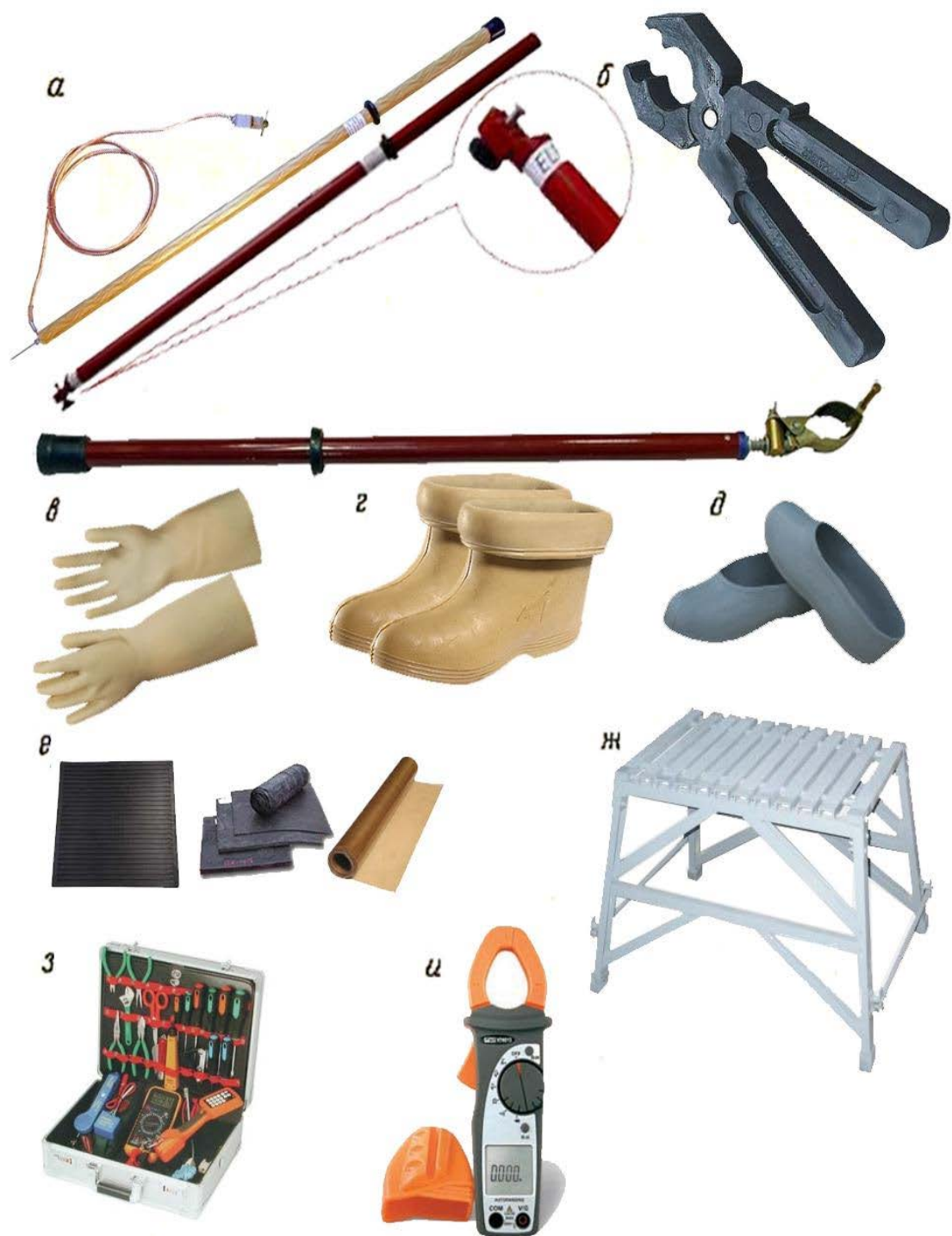
Рисунок 7 – Электрозачитные средства, применяемые в электроустановках а – изолирующие штанги; б – изолирующие клещи; в – диэлектрические перчатки; г – диэлектрические боты; д – диэлектрические галоши; е – резиновые коврики и дорожки, латкань (используется в качестве гибкого электроизоляционного материала в электрических машинах и аппаратах); ж – изолирующая подставка; з – монтерский инструмент с изолированными ручками; и – токоизмерительные клещи
