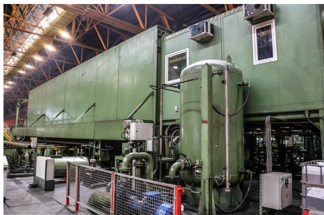
Рисунок 4 — Гидропресс для испытания труб
