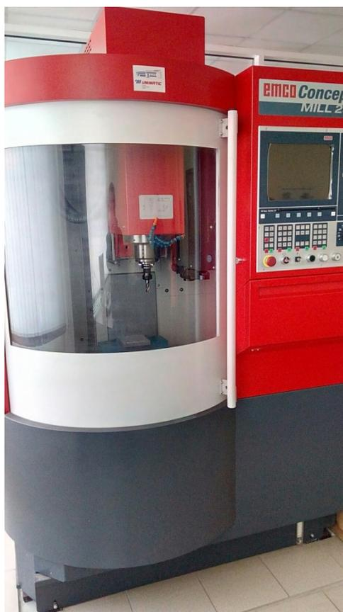
Рисунок 25 – Фрезерный станок EMCO Concept MILL 250
