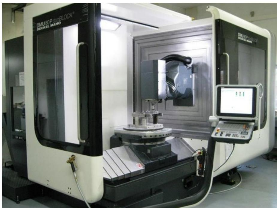
Рисунок 6 – Общий вид ОЦ DMU 60P duoBLOCK
