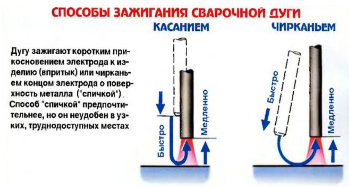
Рисунок 1 – Способы зажигания сварочной дуги
